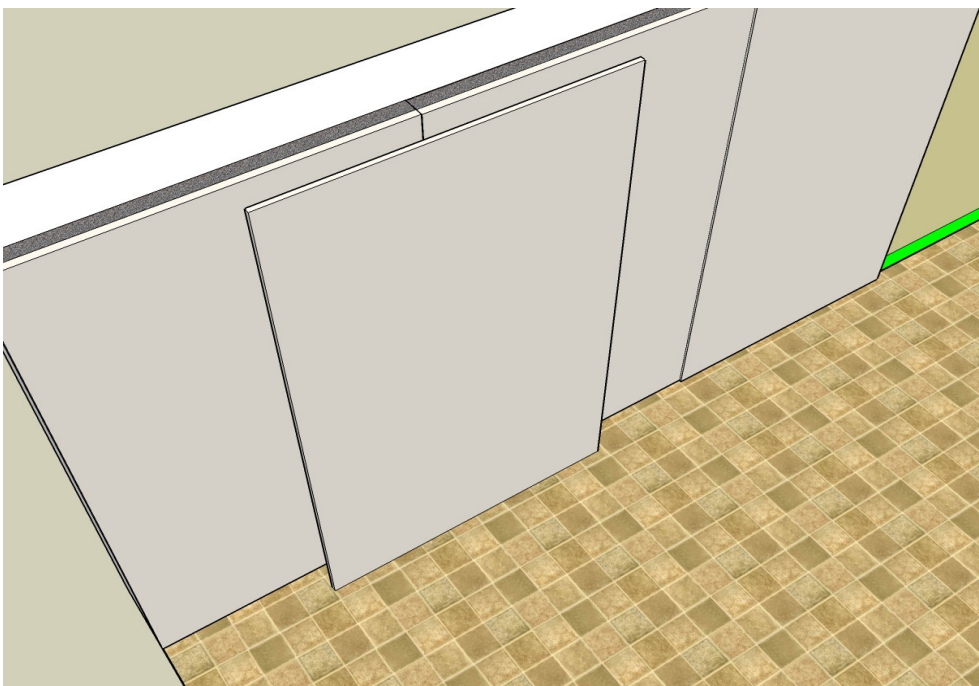
Fig. 4 – Per aumentare la massa della controparete ed aumentarne la resistenza alla compressione sarebbe opportuno posare un ulteriore pannello fonoisolante o, almeno, una seconda lastra in cartongesso avendo cura di sfalsare le giunzioni. In questo modo si chiudono eventuali passaggi di rumore tra un pannello e l'altro. A posa ultimata si può procedere con le normali operazioni di stuccatura e rasatura come se si trattasse di normali pannelli in cartongesso.
