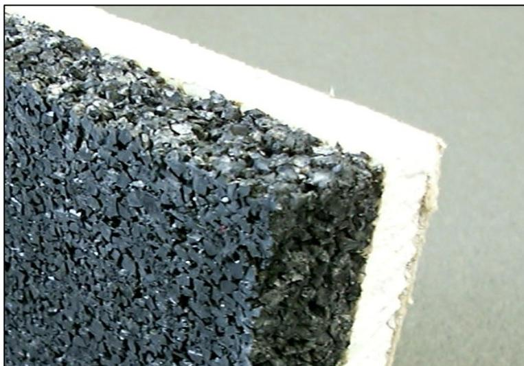
*Pannello fonoisolante in eco-rubber, agglomerato di granuli di gomma, preaccoppiato a lastra in cartongesso per la realizzazione di contropareti acustiche*
