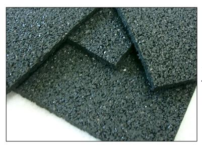
Agglomerato di granuli di gomma per isolamento fra solaio e massetto
